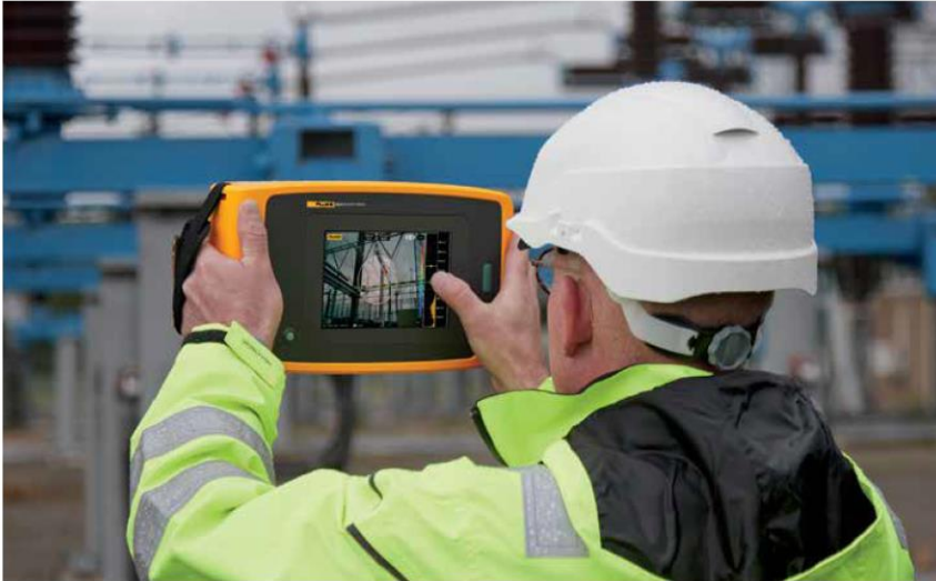
高電圧印加時の部分放電を検出する ii910 Precision Acoustic Imager の画像。
